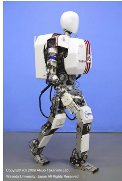
Figura 1.2: Robô WABIAN-2R, desenvolvido pela Universidade de Waseda, Japão. [31]
